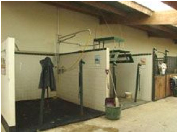
Une douche et un banc de lampes à l’écurie de l’Ellipse, ces éléments sont directement placés dans le couloir de boxes. Leurs parois sont recouvertes de carrelages, l’entretien en est facilité. Les chevaux sont attachés tête côté couloir, à des poteaux de fonte. Le sol est recouvert de caoutchouc, évitant les glissades. L’espace d’échauffement est quand à lui dans un volume trop ouvert d’où un gaspillage d’énergie
