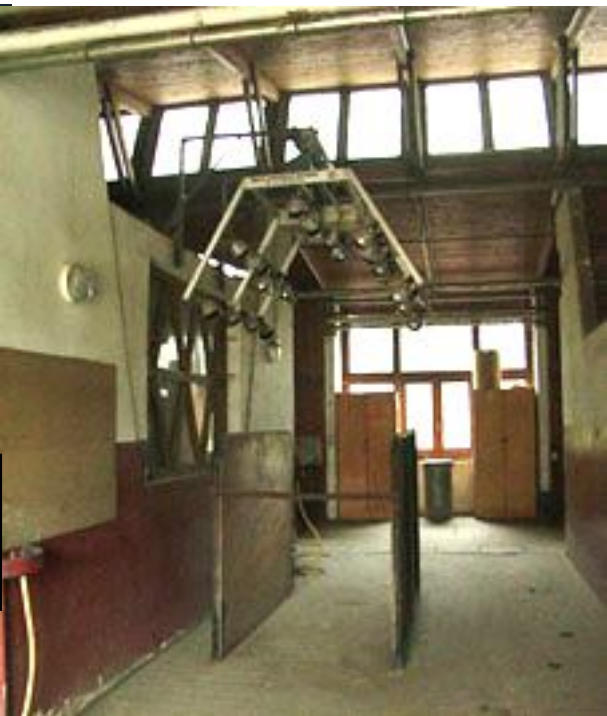
Banc de lampes ultraviolettes à l’ENE, placé en plein milieu d’une circulation et à l’air libre, d’où une déperdition importante de chaleur.
